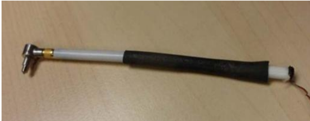
FIGURE 10: PCB PIEZOTRONICS MODEL 086E80 MINI HAMMER.
