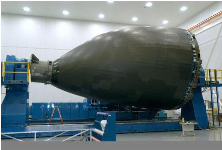
**FIGURE 2.3-1: ATP ON THE FRONT FUSELAGE SECTION OF BOEING 787 DREAMLINER [30]**
