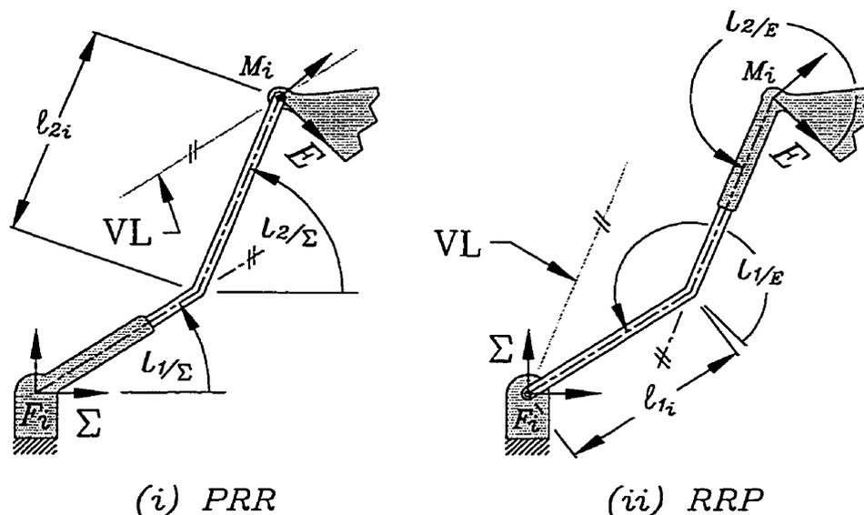
FIGURE 5.2. VL parameters for (i) a  $\underline{P}\underline{R}\underline{R}$  and (ii) a  $\underline{R}\underline{R}\underline{P}$  platform.
