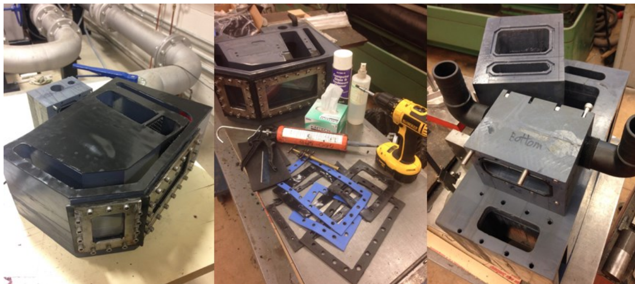
Figure 39 – Étanchéité du prototype assurée par une feuille de caoutchouc découpée selon la forme du profil 2D et couvrant la surface horizontale sur laquelle est déposée la fenêtre principale (image de gauche), des feuilles de caoutchouc rectangulaire comportant des trous aux emplacements des vis pour les autres fenêtres (image du centre) et des anneaux de caoutchouc (image de droite)
