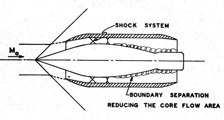
FIG. 7 DIFFUSER AT SUPERCRITICAL OPERATION SHOWING BOUNDARY LAYER SEPARATION
