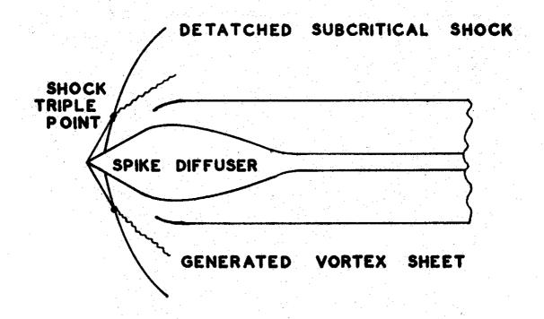
FIG. 6 SHOCK CONFIGURATION AT
