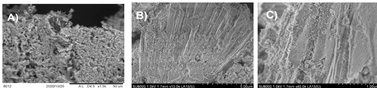
Figure 6.5 SEM images of Zr-SSA. A) 50 μm B) 5 μm C) 1 μm
