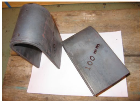
(d) U-shaped flexural plates
