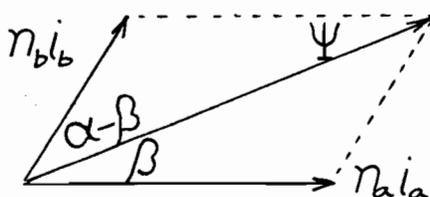
$$\Psi = \sqrt{n_a^2 i_a^2 + n_b^2 i_b^2 + 2n_a n_b i_a i_b \cos \alpha} \quad (512)$$
