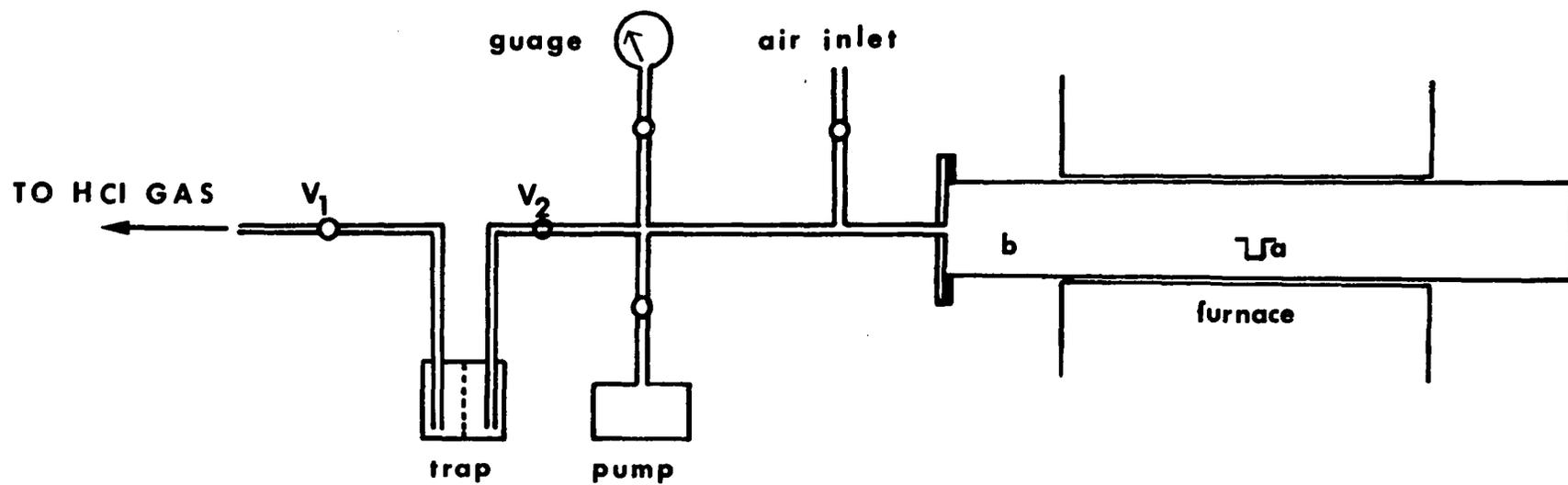
Fig. 3 Crystal annealing apparatus.
