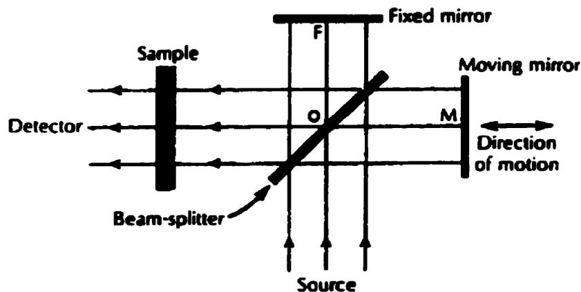
Fig. 4. Schematic diagram of a Michelson interferometer (van de Voort, 1994a)
