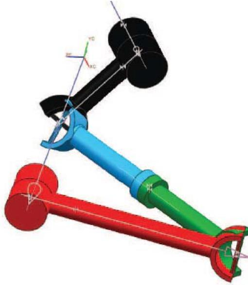
FIGURE A.2. RURUR clutch linkage
