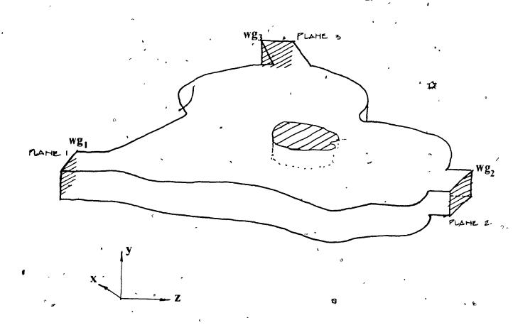
FIG 1.2 AN H-PLANE WAVEGUIDE JUNCTION
