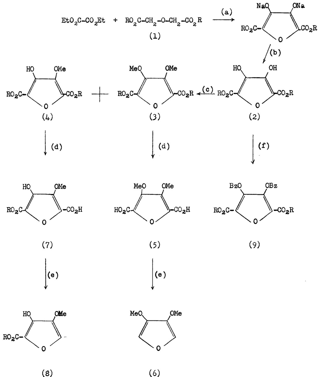
Reagents: (a) NaOR; (b)  $\text{H}^+$ ; (c)  $\text{Me}_2\text{SO}_4$ ; (d) NaOH;  $\text{H}^+$ ; (e) decarboxylation;
