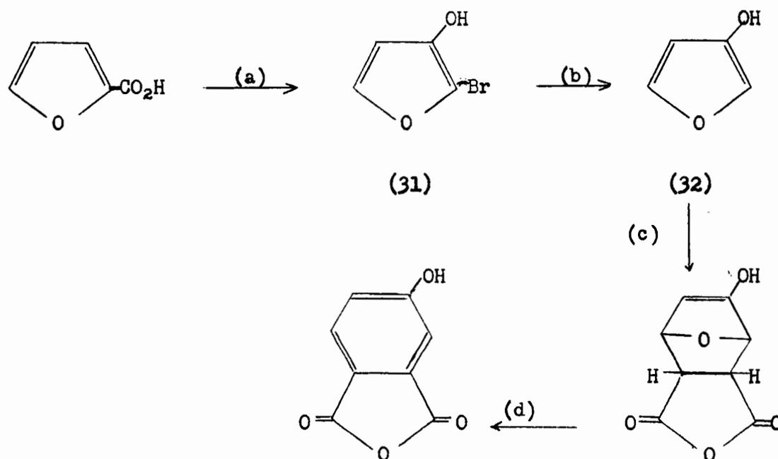
Reagents: (a)  $\text{Br}_2 + \text{H}_2\text{O}$  and  $\text{CHCl}_3$ ; (b)  $\text{Na-Hg}$ ; (c) maleic anhydride; (d)  $\text{HBr} + \text{AcOH}$
