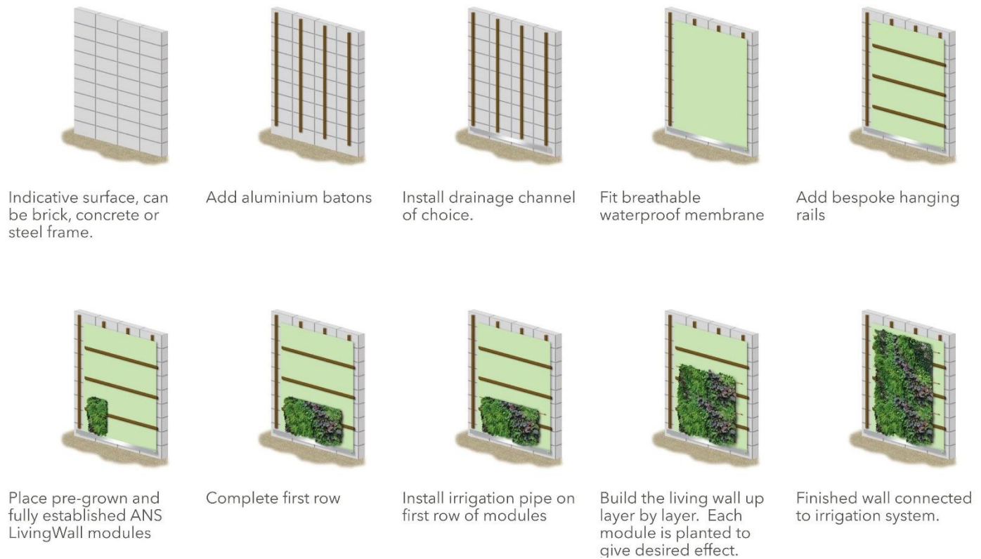
Figure 3.28: ANS Global Living Wall Assembly Diagram. ANS Global (2019). ANS Living Wall Guide.
